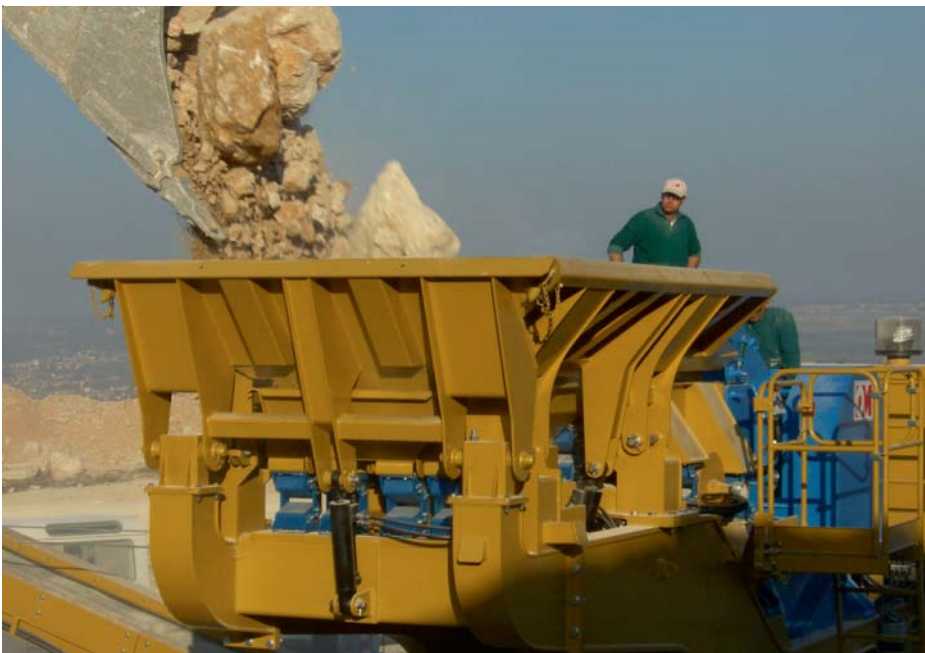
Beschickungsrinne zu mobilem Brecher auf AB-D 50-2 gelagert
