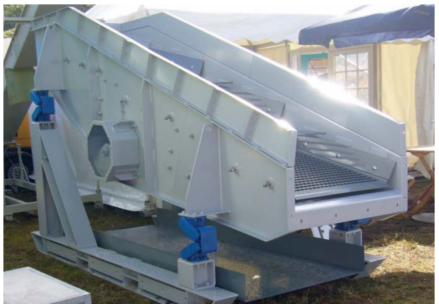
Kreisschwingsieb auf AB 50 gelagert (Ausstellungsmaschine)
